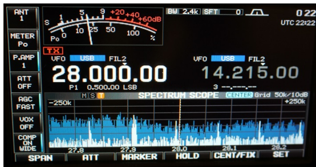
Fig. 17: Störsituation bei Betrieb eines PLC-Geräts (in 30m) mit Ausnotchung nach EN50561-1. Spektrum nachts aus NO am 16.07.2018 um 0:22 von 27.75 MHz bis 28.250 MHz bei Betrieb ohne Noise-Blanker an der unteren, fallenden Flanke des ausgenotchten Bereichs. Ref. Level -120 dBm, 10 dB/Linie, Wert an Diagramm-Oberkante -50 dBm. Im ausgenotchten Bereich: Störpegel: -80 dBm, → U (an Ant): 27 dB \mu V → E (an Ant): 18 dB \mu V/m, Antennenfaktor AF E = -9 dB/m. Band geschlossen, kein Funkverkehr.
