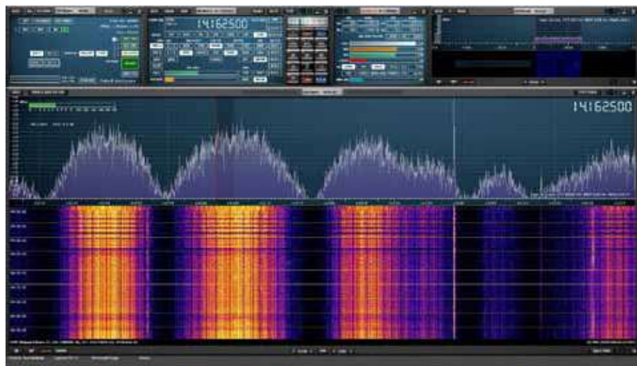
Perturbations à la station de Cressier (FR) reçue avec une beam à une distance d'environ 1.3 km de la station: Pour les radioamateurs, un tel signal perturbateur à large bande n'est pas tolérable.
