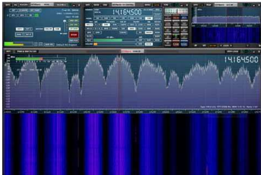
Perturbations typiques Euroloop avec un train à l'arrêt en gare de Cressier (FR)
