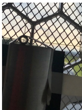
Abbildung 13 Optisches Visier, Fadenkreuz & Visier-Röhrchen (nachgerüstet)
