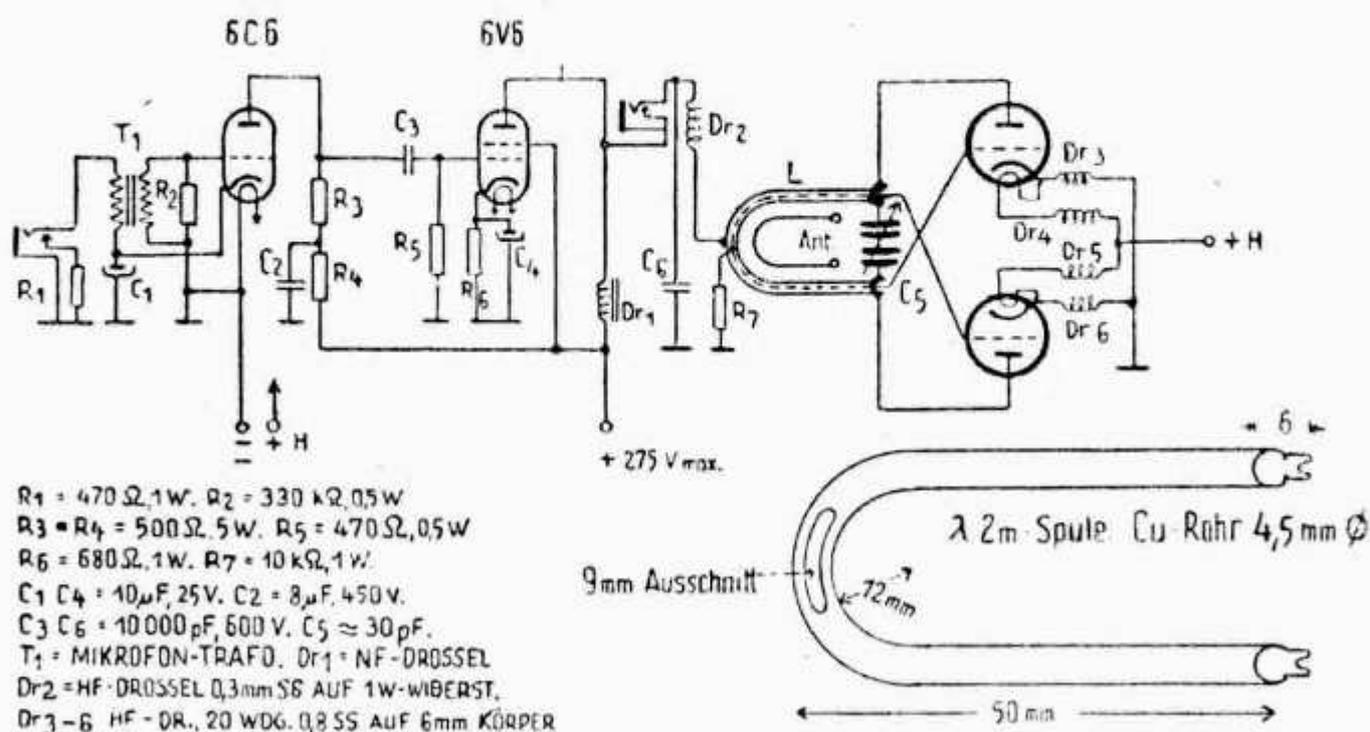
L'émetteur dont le schéma se trouve ci-dessus empêche le ronflement de la modulation en utilisant des lampes à chauffage indirect et la stabilité en est augmentée dans de fortes proportions par l'emploi d'un push-pull final. La self anodique est formée par un tube de cuivre replié en U à l'intérieur duquel se trouve la self de grille. Avec ce système, la stabilité est spécialement bonne, même si la tension anodique varie dans une forte mesure.
