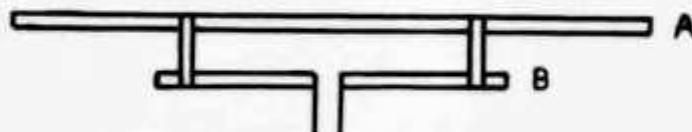
Dans un petit opuscule, j'ai trouvé une solution simple: Adaption par T-Match. Le brin rayonnant A est fait d'une seule pièce, deux pièces B de plus courte longueur sont reliées à ce brin A par deux pièces pouvant être glissées de part et d'autre du centre. Il existe deux points C et C' où l'adaptation est réalisée. Un mesureur de champ constitué par un dipôle et un système de mesures permet de comparer le champ AV et AR.
