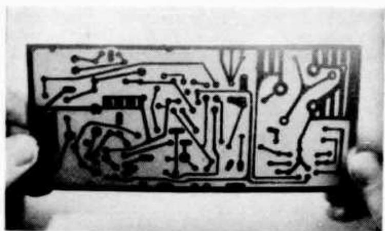
Abb. 5. — Geätzte, aber noch ungebohrte Dellitplatte.
