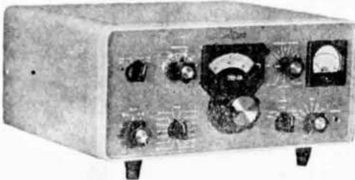
Kurzwellen-Empfänger für den Empfang von AM, SSB und CW. Frequenzbereich: 3,4...5 MHz und 6,5...30 MHz, in 14 Bändern mit 200 kHz Bandbreite.
