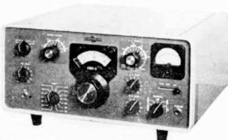
Kurzwellen-Sende-Empfänger für SSB- und CW-Betrieb.
