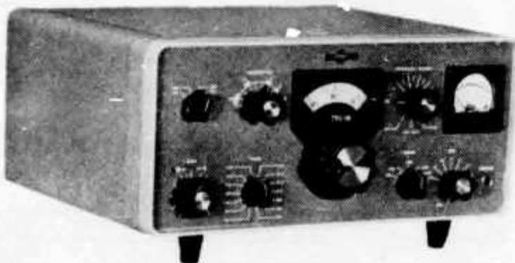
Kurzwellen-Empfänger für den Empfang von AM, SSB und CW. Frequenzbereich: 3,4 . . . 5 MHz und 6,5 . . . 30 MHz, in 14 Bändern mit 200 kHz Bandbreite.
