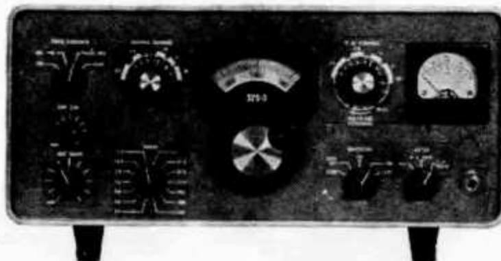
Kurzwellen-Sender für SSB- und CW-Betrieb. Frequenzbereich: 3,4 . . . 5,0 MHz und 6,5 . . . 30 MHz, in 14 Bändern mit 200 kHz Bandbreite.
