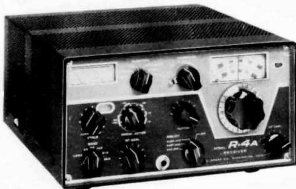
**RECEIVER R-4-A:** Mit Quarzen für 80/40/20/15 m + 28,5–29 Mc. + 10 zusätzliche Quarz-Sockel für 500-kHz-Bereiche von 200 bis 10 m (160-m-Band, WWV, Broadcast, Ships etc.). 4 Trennschärfestufen 0,4/1,2/2,4/4,8 kHz. **Passbandtuning!** Rejection Notch – Eingebauter 100 kHz-Calibrator – Grossartiger Noise-Blanker – Hervorragend kreuzmodulationsfest – 1-kHz-Skala-Genauigkeit – Doppel-ZF: 5645 und 50 kHz. – 110 und 220 A.C.
