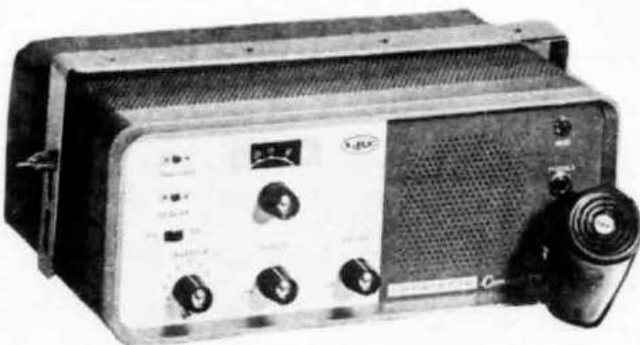
7 tubes et 3 diodes, 9 canaux contrôlés par quartz, la réception peut se faire sur tuning pour les canaux 1 à 23, Automatic noise limiter, sortie en Pi sur antenne, impédance 50 ohms, sensibilité du récepteur: 1  $\mu$ V pour 10 dB, prises phone et haut-parleur extérieur, alimentation: 11 $\frac{1}{2}$ V AC. Equipé pour le canal 11.
