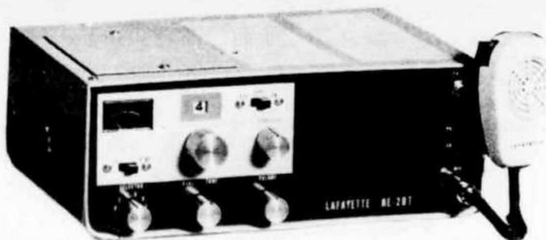
12 canaux contrôlés par quartz, émission et réception; les 23 canaux de la CB peuvent être écoutés à la réception. Filtre mécanique 455 KHz. Protection contre les charges HF. Possibilité d'utilisation comme Public address avec un haut-parleur extérieur. Trappe anti-TVI. Sensibilité: 0,7  $\mu$ V, 13 transistors et 10 diodes. Alimentation: 220V AC ou 12V DC (négatif ou positif à la masse). Equipé pour le canal 9.
