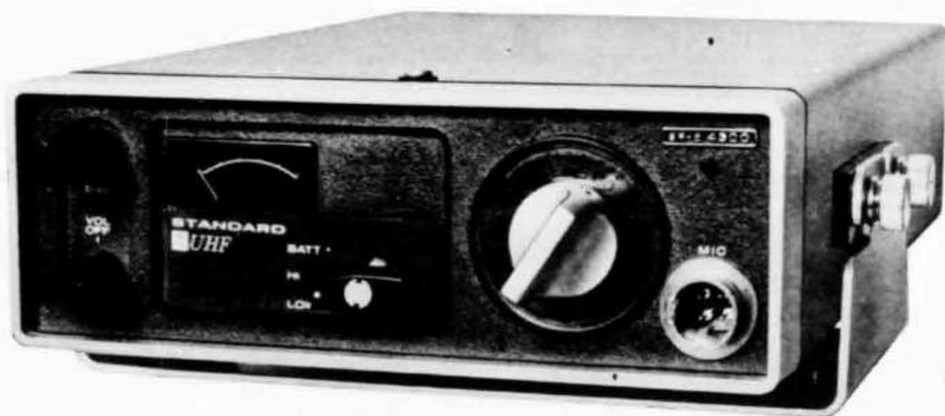
Nicht nur auf dem 2-m-Band, sondern auch auf 70 cm bietet die Betriebsart FM erhebliche Vorzüge. Besonders innerhalb von Ortschaften sind Fading und Funkschatten weniger stark ausgeprägt, da die 70-cm-Wellen stärker an den Gebäuden reflektiert werden und sich dadurch eine bessere «Ausleuchtung» ergibt.
