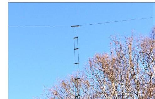
Eine einfache Drahtantenne, ein sog. Dipol
