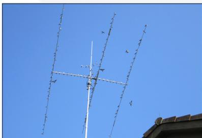
Antenne directive orientable appelée «beam», un beau perchoir pour les oiseaux; les éléments transversaux mesurent env. 8 m
