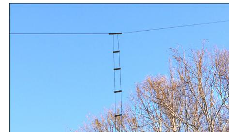
Antenne filaire du type dipôle avec sa ligne d'alimentation symétrique dénommée «échelle à grenouilles»
