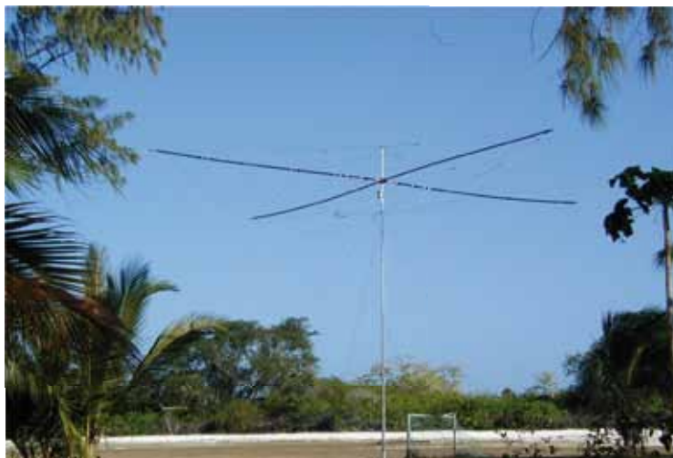
Spiderbeam der FT5GA-Expedition am Rand eines verlassenen Fussballfelds auf Glorioso. Auf der Insel ist ein kleines Detachement der französischen Fremdenlegion stationiert.
