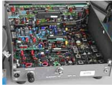
Photo 2: Vue sous le «couvercle» du K2
