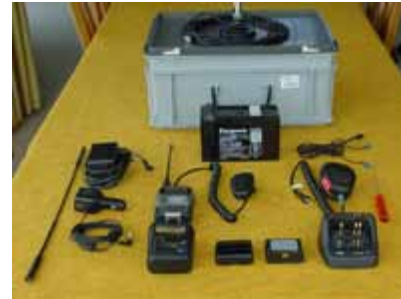
Der Notfunkkoffer von HB9AJW (Version Handheld)
