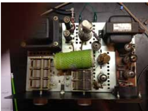
MW-TX mit 25 Watt Output
