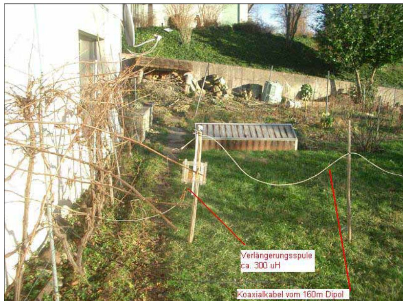
Verlängerungsspule (ca. 300 \mu H) am Koax des 160- Dipols
