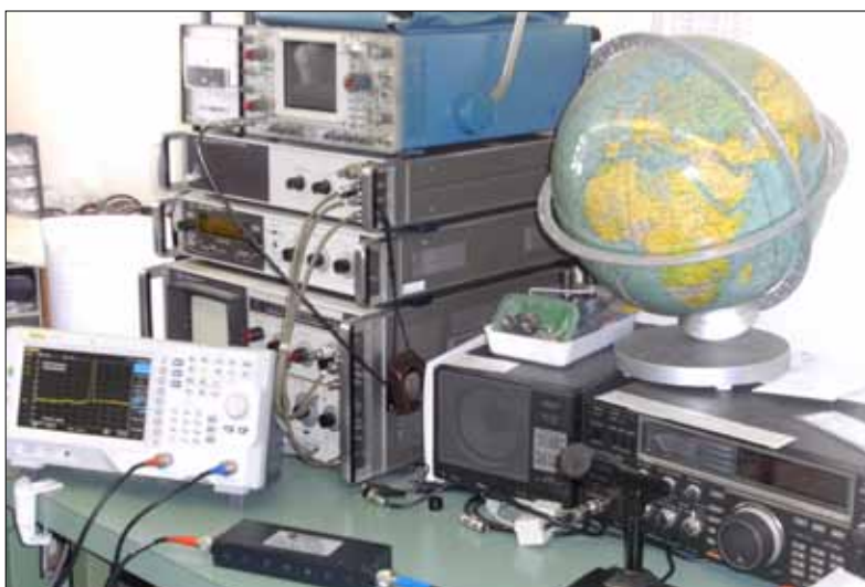
Photo 11: TRX IC-765 (r.); links von oben: Tektronix Oszilloskop, 2 Tracking Oszillatoren (bis 1,25 GHz), Spektrum-Analyzer HP141D und Rigol Spektrum/Tracking-Analyzer bis 1,5 GHz (mit Rubidium-Atomfrequenznormal; Genauigkeit: 10^{-10} )
