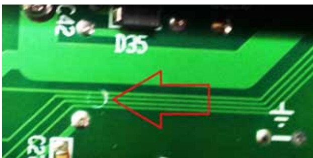
Durchtrennte Leiterbahn im K3
