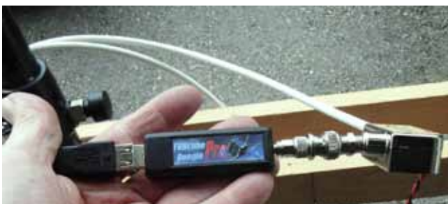
Le Funcube Pro+ et le T-bias qui injecte le 12V sur le coax
