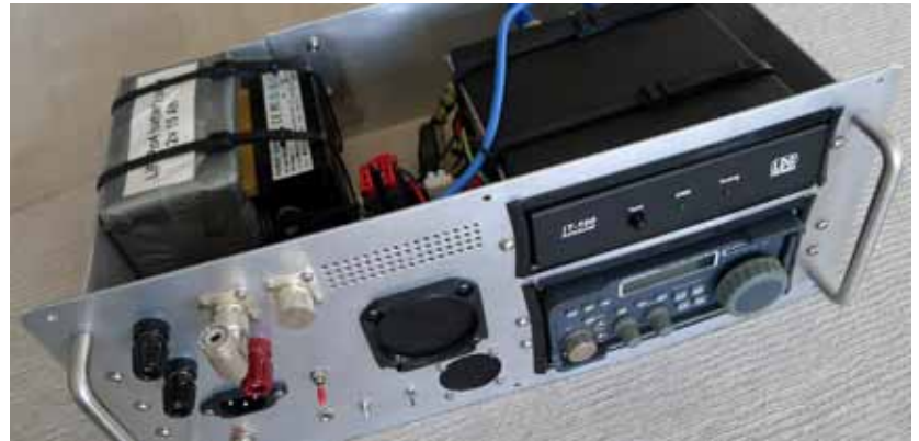
Construction HF Go Kit - TRX: SG 2020 et ATU: LDG IT 100
