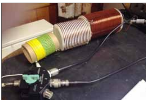
Verlängerungsspule mit Antennenschalter
